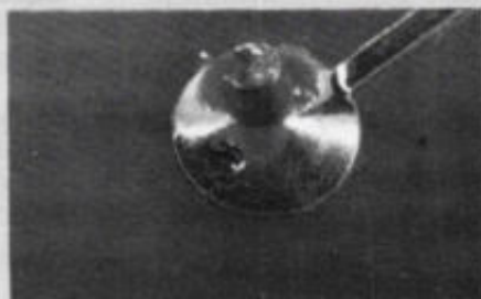
Krater of „blowhole“ in een vloeiprofiel.
