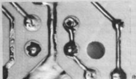
Verschiedende graden van soldeerontvochtiging bij geëtsde verbindingspatronen op een printplaat: (a) 90% ontvochtigd; (b) 15% ontvochtigd.
