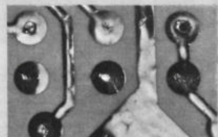
Onvolledige soldeerbevochtiging bij geëtste verbindingspatronen op een printplaat: (a) 85% bevochtigd; (b) 98% bevochtigd; (c) perfect bevochtigd.
