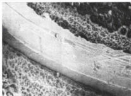
Afb. 8. Detail van een boorgatwand waarin het aangeboorde koper van een signaallaag enkele micrometer uit de wand is vrijgekomen, zodat bij doormetallisatie een driepunts-aanhechting wordt verkregen.
